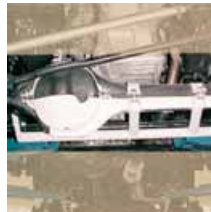
Protectores de transfer y diferencial
